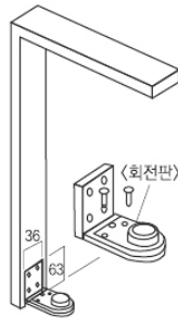
③ 후레임 하단에 하부 브라켓을 홈파기한 부위에 끼워 넣은 후 4개의 스크류를 채워 고정합니다. 이 때 닫히는 문이 문틀의 중심에 복귀하지 못했다면 회전판을 좌우로 조정하여 중심에 오도록 위치를 설정한 후 3개의 스크류를 최대한 잠금합니다. 헐렁하게 채워지면 문의 정확한 작동이 불가능합니다.
